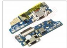
Placa auxiliar con conector de carga, datos y accesorios Micro USB para
