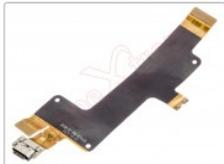
Flex de interconexión de placa base a placa auxiliar y conector de carga,
