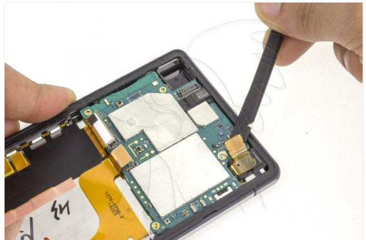
Separe la placa base haciendo palanca suavemente con la herramienta de apertura.
