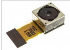
Cámara trasera de 20Mpx para Sony Xperia Z1, L39H, L39T, C6902, C6903,
