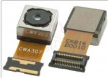
Cámara trasera de 13 Mpx LG K10 (2017) , M250N / LG X POWER 2, M320
