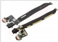
Cable flex con conector USB tipo C de carga y conector de audio OnePlus 5,
