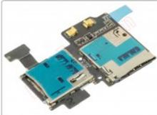
Flex con conector de tarjeta SIM y tarjeta de memoria microSD para Samsung
