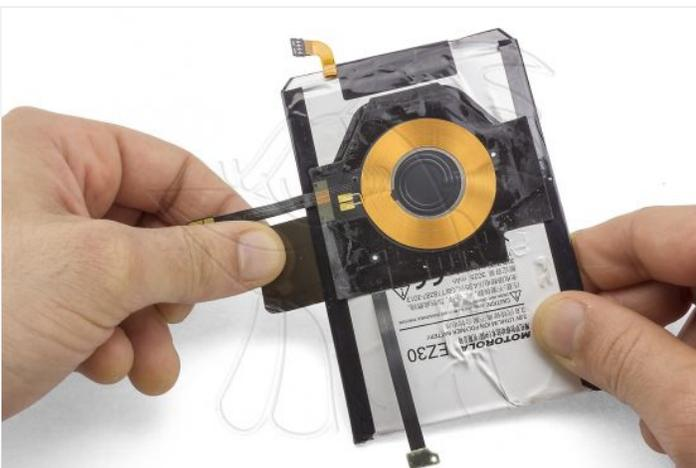
Finalmente, despegue la bobina de carga inductiva de la batería. La instalaremos de nuevo en la batería que instalemos.
