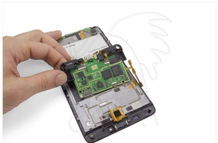
Desconecte el flex inferior, que mantiene unida la placa base. Para ello, accione la pestaña del conector y tire suavemente.
