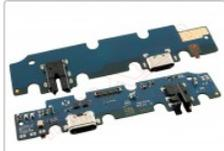
Placa auxiliar calidad PREMIUM con conector de carga USB tipo C,
