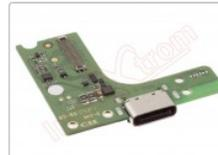
Placa auxiliar PREMIUM con componentes para TCL Tab 10s, 9081X.
