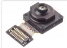
Cámara frontal de 16 mpx para Huawei P40 Lite 5G (CDY-NX9A)
