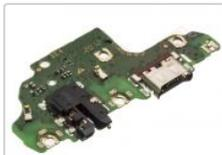
Placa auxiliar calidad PREMIUM con conector de carga, datos y accesorios
