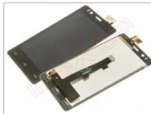
Pantalla completa IPS LCD (LCD/display, ventana táctil y digitalizador)
