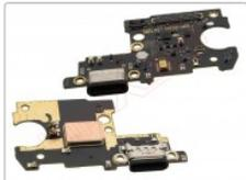
Placa auxiliar Service Pack con conector de carga USB tipo C y micrófono para
