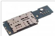
Placa auxiliar de calidad PREMIUM con componentes para Samsung
