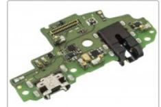
Placa auxiliar calidad PREMIUM con conector Micro USB de carga, datos y
