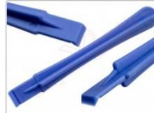
Herramienta plástica de apertura para dispositivos electrónicos
