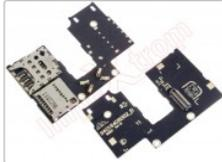
Conector con lector de tarjeta SIM y SD Motorola Moto G, XT1541
