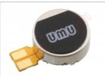
Vibrador genérico de 11 x 7,9 x 3,5 mm
