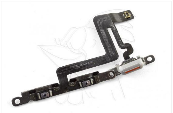
Para extraer las teclas, simplemente presione desde fuera y tire suavemente del enganche metálico.
